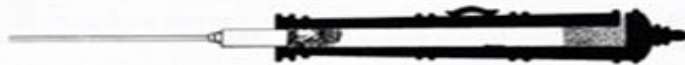
Le boulet, avant d'être mis en place à l'aide d'un refouloir, est préalablement roulé dans l'étaupe
